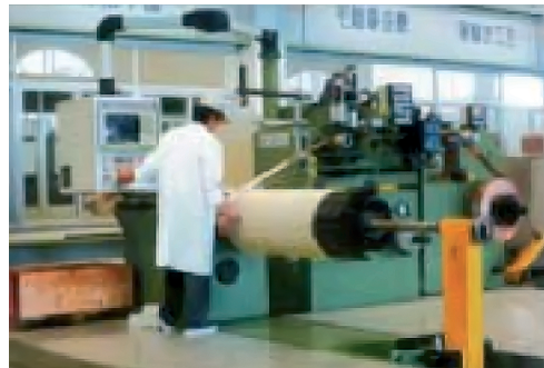
Намоточная машина для изготовления обмоток ВН (завод в Швейцарии)
