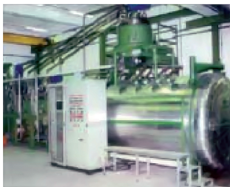
Установка для литья в вакууме (завод в Италии)
